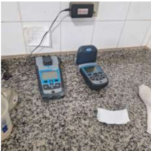
Foto 3 - Medidor de cor e medidor de turbidez - ETA
