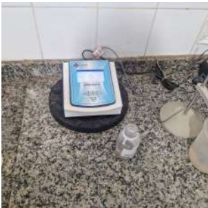
Foto 2 - Medidor de pH - ETA
