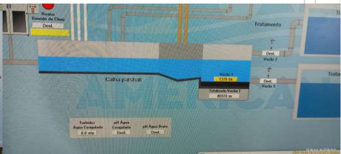
Foto 2 - Sistema de telemetria das vazões da ETA e dos reservatórios.
