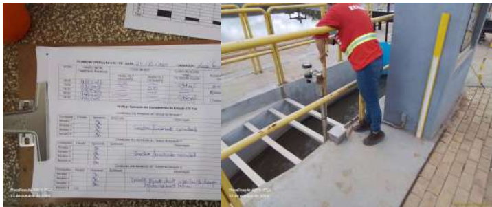
Foto 1 - Registro de vazão pelo operador. Foto 2 - Operador medindo a vazão.
