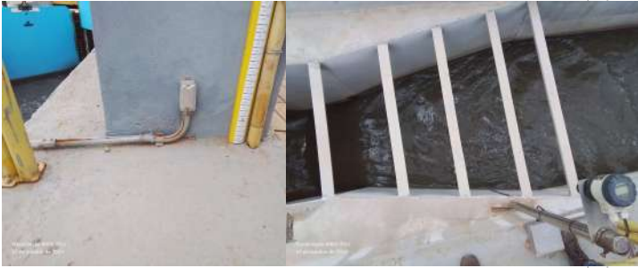
Foto 3 - Consulta no gabarito. Foto 4 - Calha Parshall com graduação de nível para medição.
