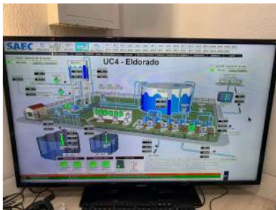
Foto 1 - Interface de monitoramento da unidade no CCO.
