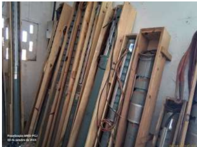
Foto 3 - Bombas reservas de poços.
