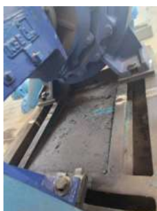
Foto 1 - Ralo para drenagem da água de lubrificação.
