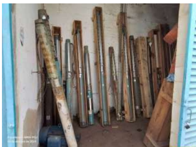
Foto 1 - Bombas reservas de poços.
