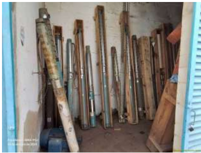
Foto 1 - Bombas reservas de poços.
