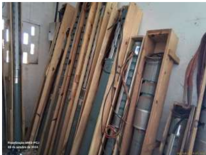
Foto 3 - Bombas reservas de poços.
