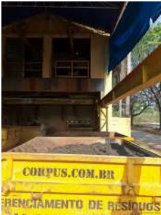
Foto 1 - Lodo desidratado por centrífuga disposto em caçamba
