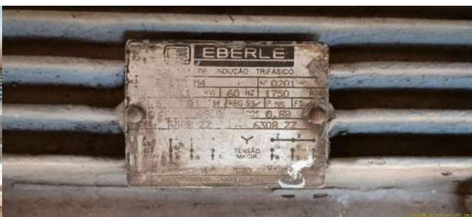
Foto 9 - Placa de especificações técnicas do motor do primeiro conjunto motobomba.
