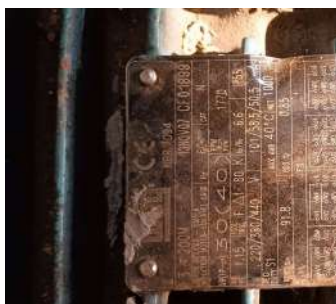
Foto 12 - Placa de especificações técnicas do motor de um dos conjuntos motobomba.
