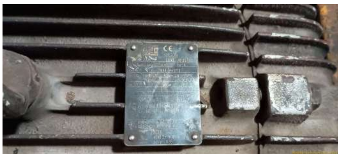
Foto 10 - Placa de especificações técnicas do motor de um dos conjuntos motobomba.
