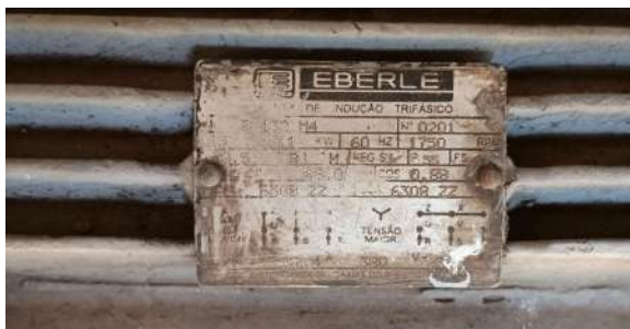
Foto 9 - Placa de especificações técnicas do motor do primeiro conjunto motobomba.
