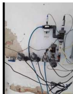
Foto 8 - Sensores que analisam os parâmetros de qualidade da água.
