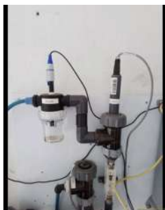
Foto 9 - Sensores que analisam os parâmetros de qualidade da água.
