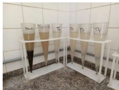
Foto 21 - Análise de sólidos sedimentáveis em cone imhoff
