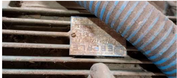
Foto 11 - Placa de especificações técnicas do segundo conjunto motobomba.
