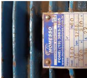
Foto 7 - Placa de especificações técnicas do primeiro conjunto motobomba.
