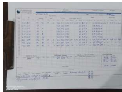
Foto 4 - O totalizador de 24 horas é anotado em planilha de controle (8 hrs da manhã). Valor em 24/07/2024: 455082 m³.
