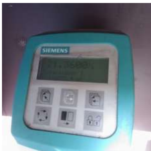
Foto 9 - Display do macromedidor.
