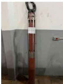
Foto 1 - Bomba reserva em estoque
