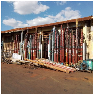
Foto 5 - Bombas reservas dos poços
