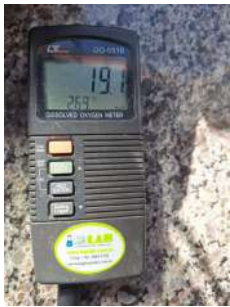
Foto 8 - ETE Sítio Novo - medidor de oxigênio dissolvido
