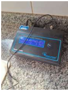
Foto 7 - ETE Sítio Novo - medidor de pH
