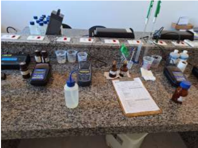
Foto 16 - Bancada de análises físico químicas. Equipamentos para medida de pH, cor, turbidez e cloro residual livre
