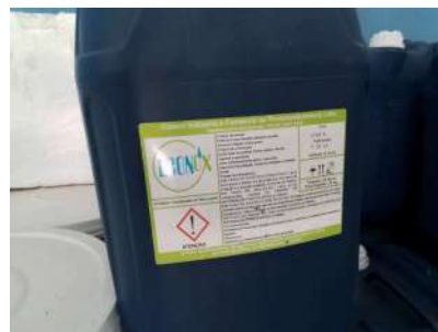
Foto 22 - Produto (ortopolifosfato de sódio líquido) utilizado para controle de corrosão na rede de abastecimento.
