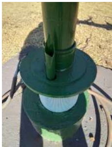
Foto 1 - Tubo de medição de nível. Recomenda-se tampar o Tubo de Medição de Nível quando não estiver em uso.
