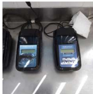
Foto 4 - Equipamentos para medir cor e turbidez.
