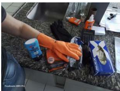
Foto 1 - EPIs de laboratório. Luva de borracha com tamanho inadequado.
