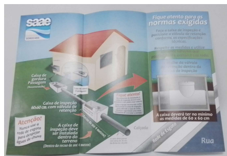
Foto 3 - Orientações sobre ligação de esgoto
