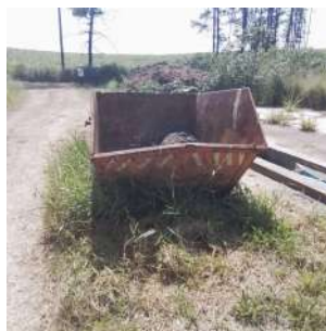
Foto 4 - Caçamba com material retido no gradeamento grosseiro.
