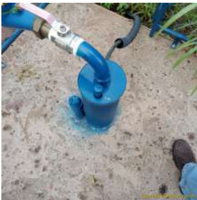
Foto 1 - Tubo de medição de nível do poço.
