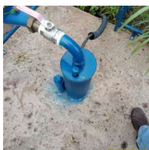
Foto 1 - Tubo de medição de nível do poço.
