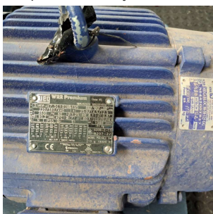
Foto 7 - Placa de especificações técnicas do motor do segundo conjunto motobomba.
