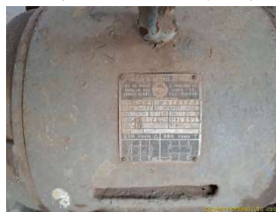
Foto 4 - Placa de especificações técnicas do motor de um dos conjuntos motobomba da EEAT.
