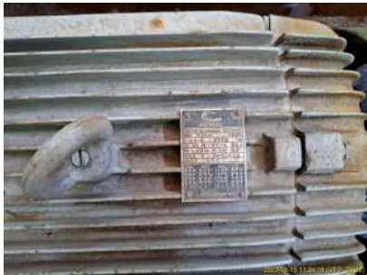
Foto 9 - Placa de especificações técnicas do motor do conjunto 2.
