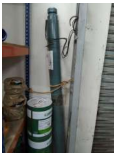
Foto 1 - Bomba reserva do Poço Chácara Alvorada 3 em estoque (Fonte: SAMAE Mogi Guaçu, 20/06/2023).
