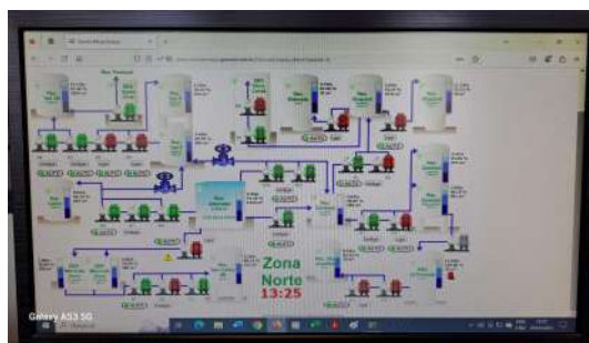
Foto 2 - Sistema de telemetria do abastecimento de água de Mogi Guaçu.
