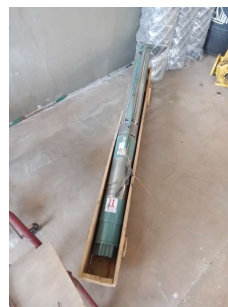
Foto 2 - Bomba Submersa Reserva (poços menor vazão)
