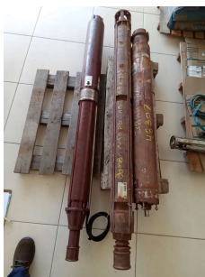
Foto 1 - Bomba Submersa Reserva
