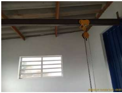
Foto 3 - Talha para içamento
