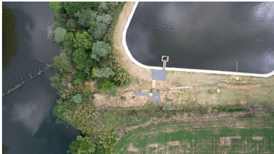
Foto 7 - Detalhe da saída da lagoa facultativa até o lançamento do efluente tratado no corpo hídrico.
