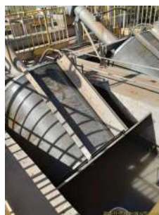
Foto 30 - Gradeamento fino por peneiras rotativas.
