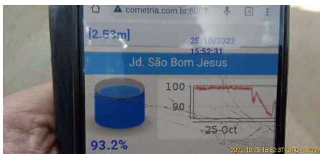
Foto 4 - Medição de Nível - Telemetria
