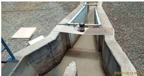
Foto 6 - Medidor de vazão de chegada.
