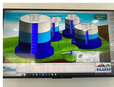
Foto 3 - Monitoramento dos níveis dos reservatórios realizado no COO do Saaesp.
