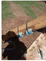
Foto 3 - Sensores para medição da vazão.
