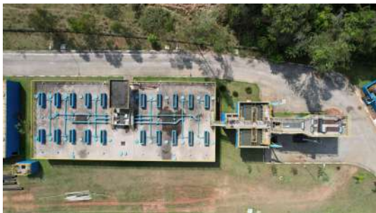
Foto 12 - Reator Anaeróbio de fluxo ascendente (RAFA) à esquerda e gradeamento fino à direita.
