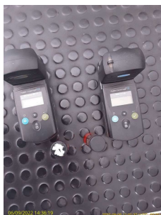
Foto 5 - Medidor de cloro residual da ETA Monte Alegre
