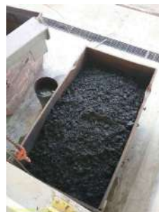
Foto 31 - Lodo de esgoto após centrifugação
