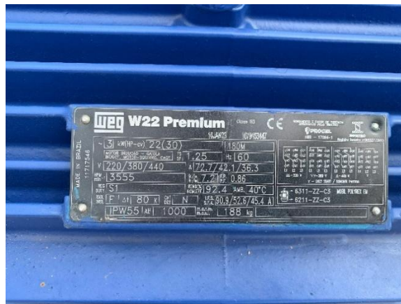
Figura TEC 7 – Conjunto Motobomba KSB Monobloco METBF 080-050-200 com motor de 30 CV, 3500
