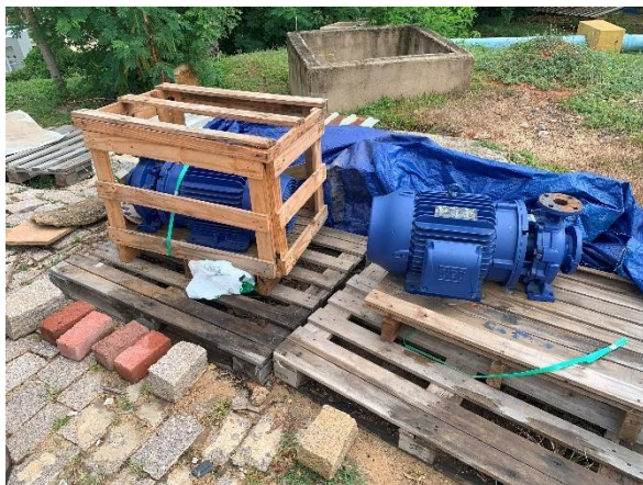
Figura TEC 7 – Conjunto Motobomba KSB Monobloco METBF 080-050-200 com motor de 30 CV, 3500
