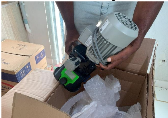
Figura TEC 8 – Bomba dosadora PRIUS
