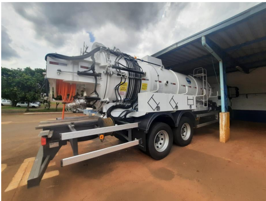
Figura TEC 1: Caminhão e equipamento de hidrojateamento
