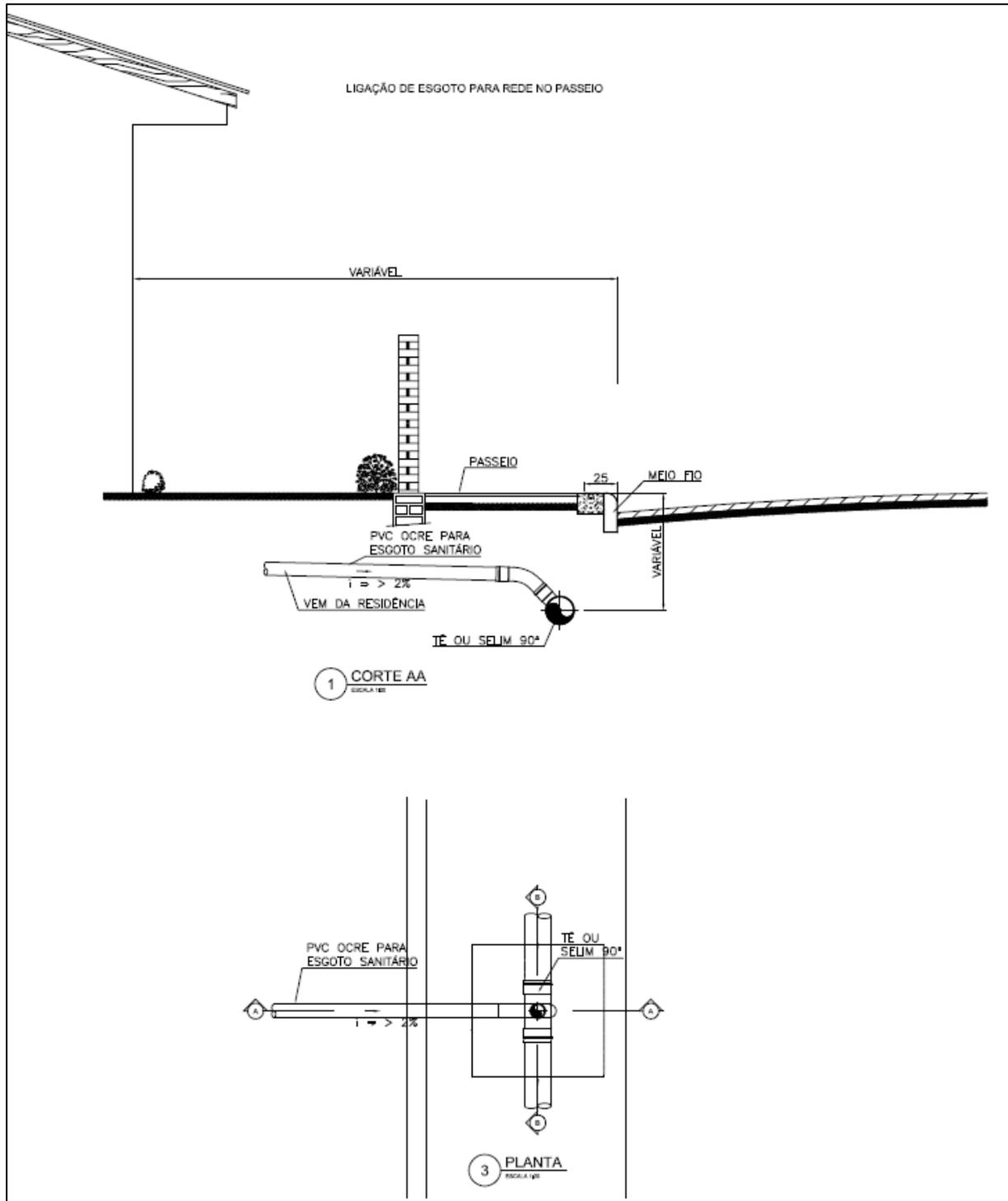
**Figura 03: Detalhe da ligação de esgoto no passeio**
