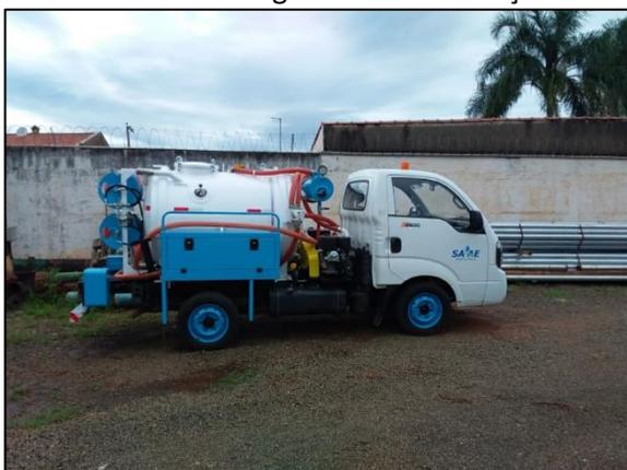
Figura 9 – Item 7.4 – Equipamento hidrojetado e vácuo para setor operacional.
