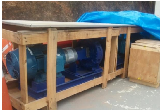
Bombas adquiridas em ago./2019, para a EEAT da ETA que vai recalcar para Reservatório Camargo
