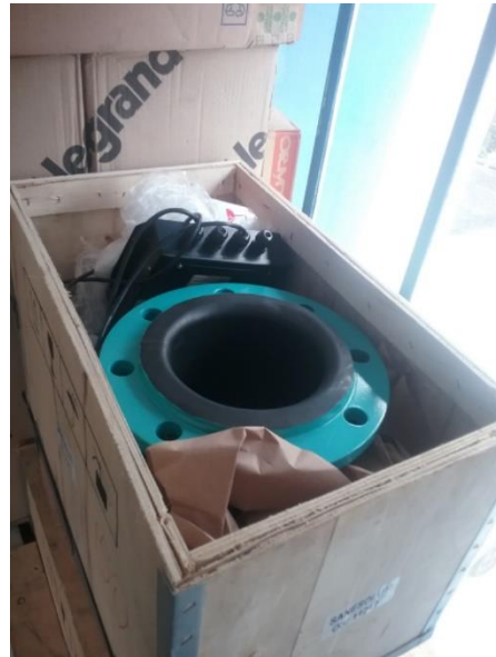
Detalhe dos medidores de vazão eletromagnéticos adquiridos (ago/2019)
