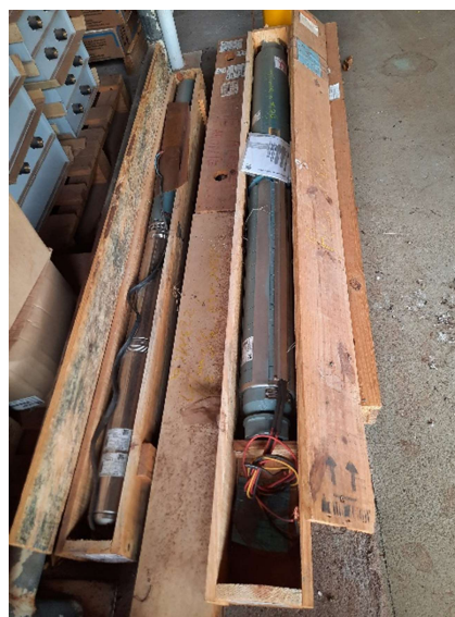
Figura TEC 9 - Equipamentos (bombas reservas)
