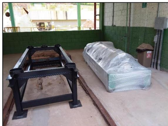
**Figura 10 – Item 10 – Aquisição de centrífuga para desidratação de lodo.**
