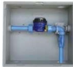
A caixa de proteção para hidrômetros padrão SAEP oferece opções de instalação com saídas pelo lado direito ou esquerdo, conforme a figura 1. O tubo camisa deve ser instalado no furo existente na parte inferior da caixa, sempre do lado oposto à saída da tubulação que vai para o imóvel.
