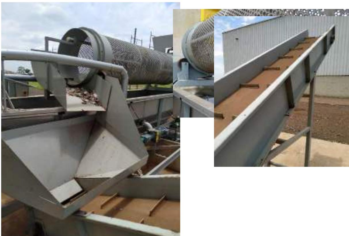
**Figura 4:** Peneiras e esteiras que deveriam encaminhar os resíduos para dentro dos biodigestores anaeróbios do CTR Palmeiras, paradas no dia da vistoria, realizada em 03.12.2019.
