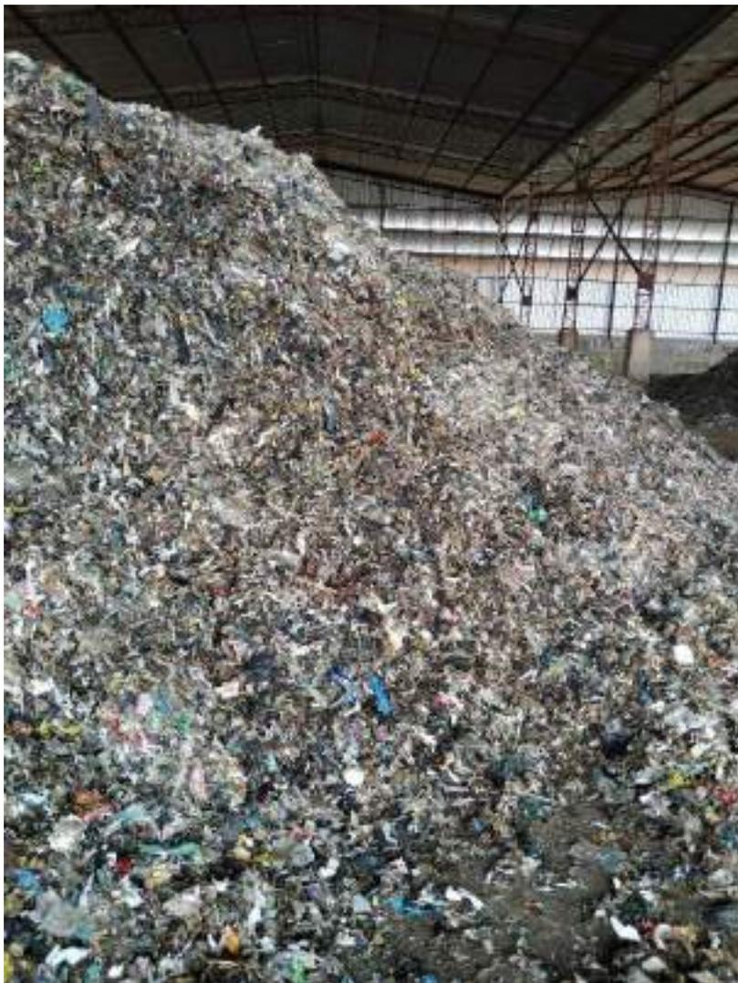
**Figura 14: CDR pronto para transporte para receber a destinação final que, no caso, trata-se de incineração no forno de clínquer. Foto da vistoria de 03.12.2019.**
