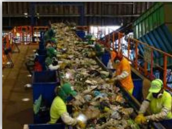
Figura 11: Esteira de triagem manual com elevada velocidade e espalhamento insuficiente do resíduo no TMB do CTR Palmeiras. Note-se a esteira abarrotada de resíduos, dificultando a operação.
