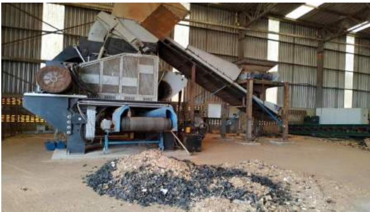
**Figura 7: Resíduos de pneus após processamento no triturador. Foto da vistoria de 03.12.2019.**
