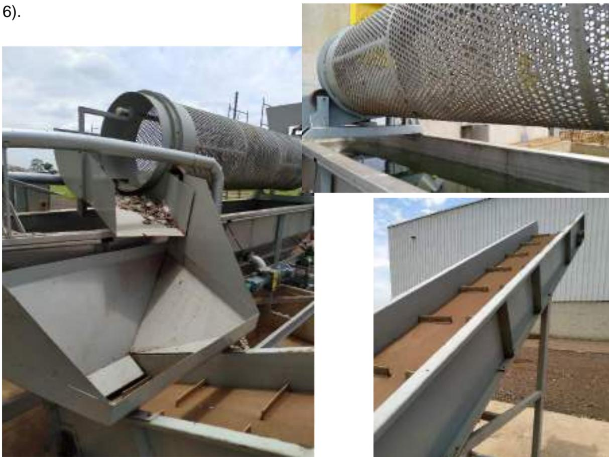
**Figura 6:** Peneiras e esteiras que deveriam encaminhar os resíduos para dentro dos biodigestores anaeróbios do CTR Palmeiras, paradas no dia da vistoria, realizada em 03.12.2019.
