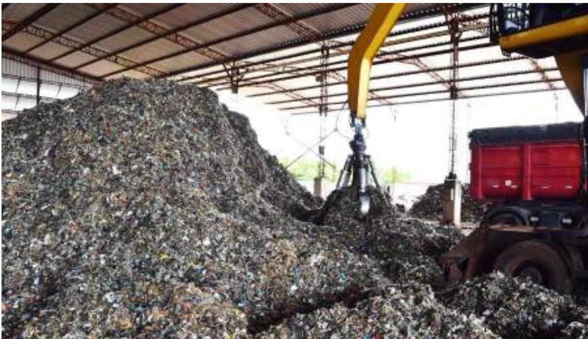
**Figura 15: CDR já processado, sendo carregado para abastecimento de cliente externo. Foto da vistoria de 03.12.2019.**
