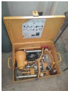
Descrição(7): Kit emergência para vazamento de cloro
