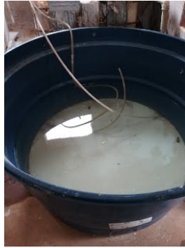
Descrição(16): mistura de barrilha em substituição da cal Imagem(17)
