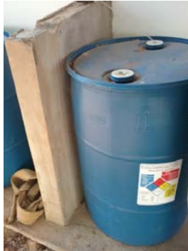
Descrição(4): Bombonas de flúor e cloro - armazenagem inadequada de produtos químicos Imagem(5)
