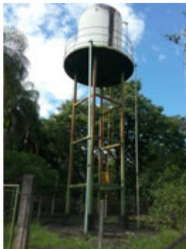
**Descrição(1):** Vista geral do Reservatório do Congonhal com a base em estrutura metálica e o reservatório em fibra de vidro.
