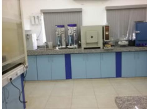
**Descrição(3):** Mufla, filtros e destilador de água para uso em laboratório
