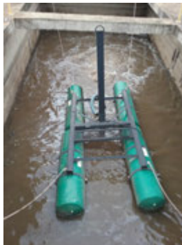
Descrição(8): Lodos ativados por batelada com aeradores
