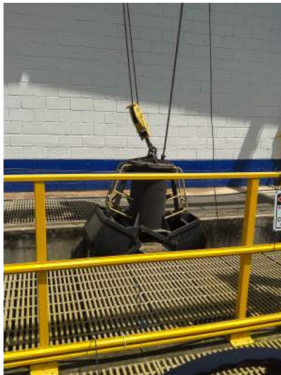
Dispositivos de Retirada de Sólidos Grosseiros e Finos.
