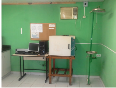
Descrição(3): Detalhes do chuveiro de emergência e da mufla do laboratório.
