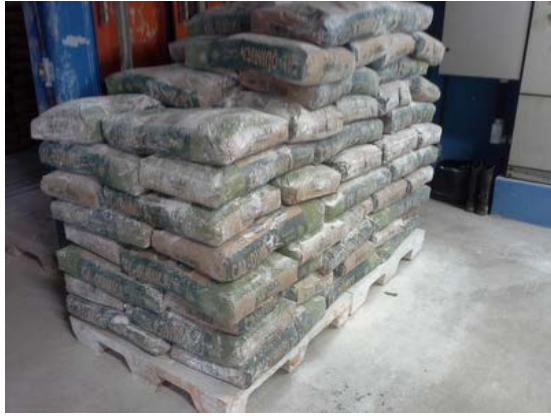
Descrição(17): Depósito de Cal hidratada
